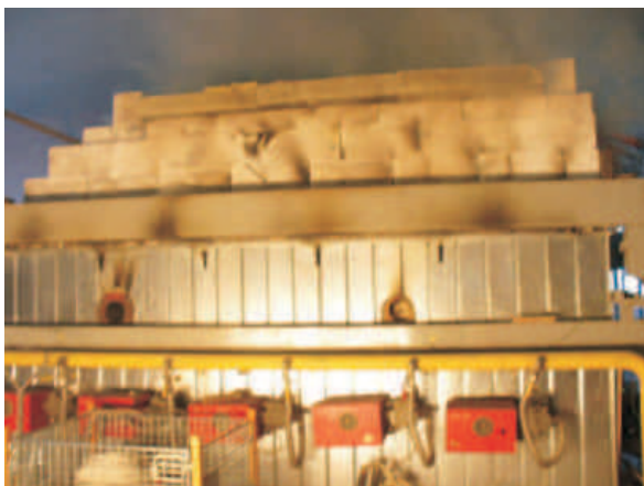
Огневая камера, предназначенная для тестов, согласно DIN 4102-12
